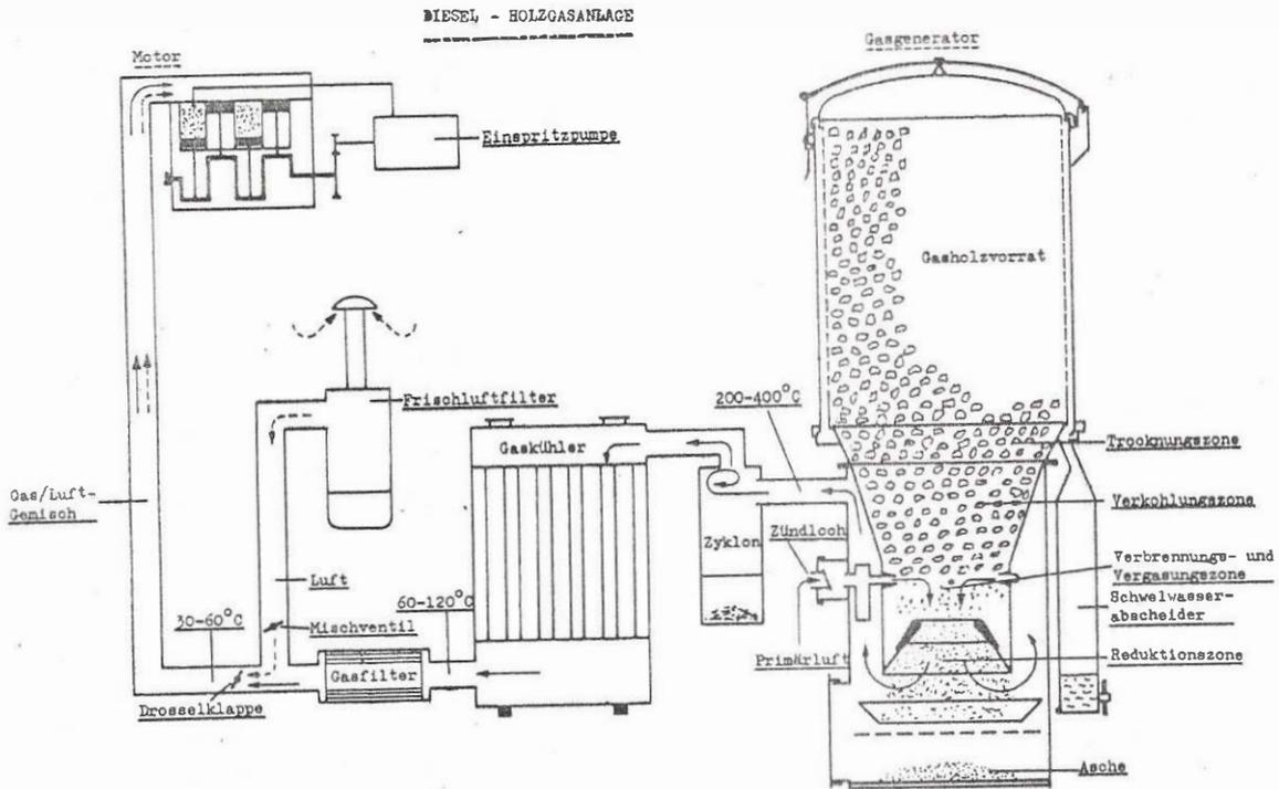
Abb. 2: Funktionsschema der Dieselholzgasanlage.
